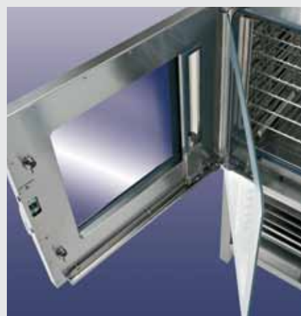
Doppio vetro atermico, temperato, ad intercapedine d'aria ed apribile a libro dall'interno per la pulizia
